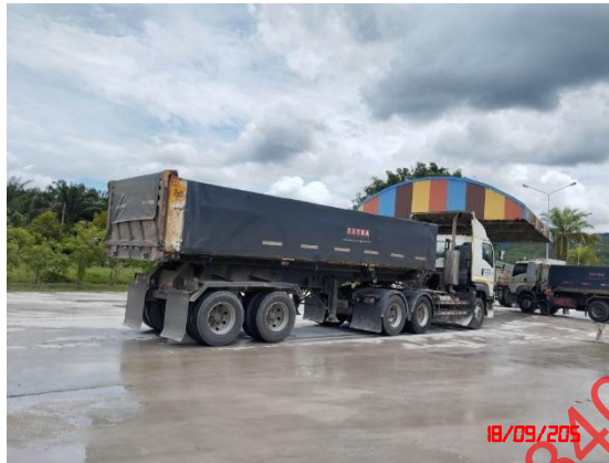
รูปที่ 7 การใช้ผ้าใบปิดคลุมท้ายกระบะรถบรรทุก
